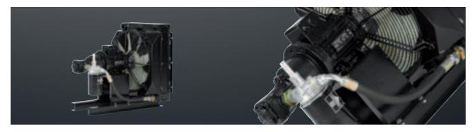
Die OPC Ölkühlereinheit ist ein speziell entwickeltes System für die Kühlung im Nebenstrom als autonome Einheit. Die Einheit besteht aus Kühler, Ventilator, E-Motor, Pumpe und kann auf Kundenwunsch um den Filter erweitert werden.
