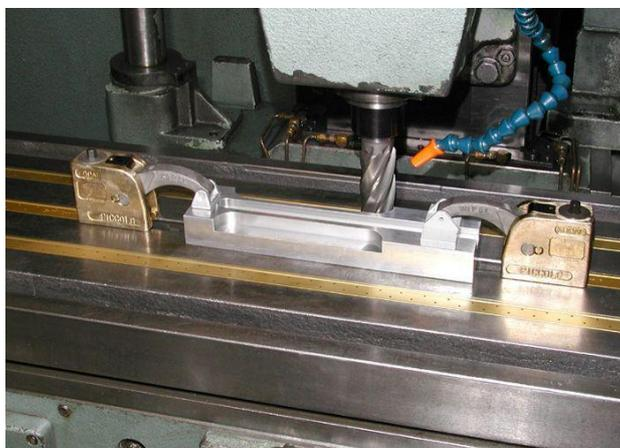
Система представляет собой прочный корпус из сплава бронзы и алюминия. В корпусе зажима установлен червячный винт, а также зажимная штанга, сопряженная с червячным винтом посредством зубьев. Путем вращения червячного винта при помощи ключа приводится в движение зажимная штанга, которая фиксирует заготовку.
