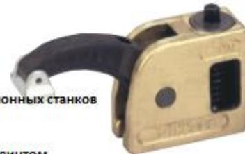
Зажим серии Piccolo специальный, предназначен для электроэрозионных станков в корпусе из сплава бронзы и алюминия, в комплекте с ключом и фиксационным винтом, алюминиевым контактным наконечником, стальной зажимной штангой и стальным червячным винтом
